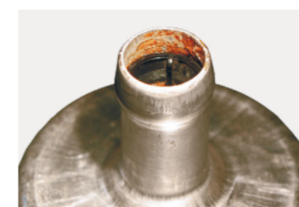
Verrosteter Pumpeneinlauf (Wasserschaden)
