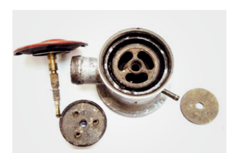
Pneumatisches Sekundärluftventil: Schäden durch Kondensat
