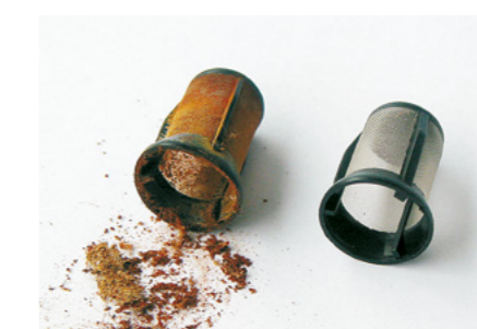
Verstopfter Siebfilter und Neuzustand
